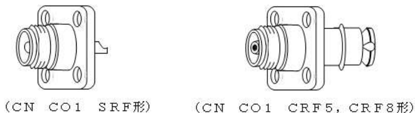
第 23-1 図 JIS C 5411 CO1 形コネクタ外観図
