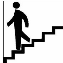
第17-44図 階段のシンボルを用いた階段始点用の標示の例
