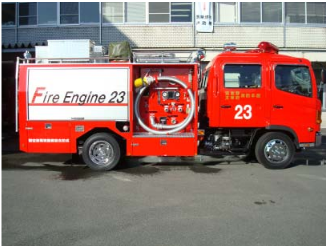
災害対応特殊水槽付消防ポンプ自動車（筑紫野消防署配置）
