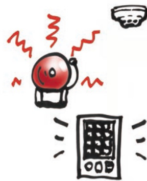
自動火災報知設備
