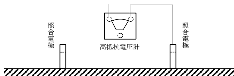
第 17－2 図 地表面電位こう配測定方式
